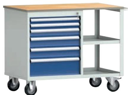
1.000 × 620 × 830 mm L × T × H, mit Buchen-Multiplexplatte 1.000 × 620 × 20 mm und folgender Ausstattung: links: 50EA/50EA/75EA/100EA/100EA/175EA; rechts: zwei offene Ablagefächer, mit Schiebepögel; sowie 2 Lenkrollen mit Feststeller und 2 Bockrollen (Ø 125 mm).
