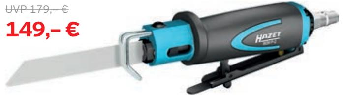
Leistungssteigerung bei gleichzeitiger Reduzierung von Gewicht, Luftverbrauch, Geräuschentwicklung und Vibration • Luftauslassrichtung justierbar • Für kleine Sägeradien geeignet • Schneidleistung Aluminium: 4 mm • Schneidleistung Stahlblech: 3 mm • Hübe / Min.: 9500 • Durch die Aufnahme von Feilenblättern (im Lieferumfang) insbesondere zur Reinigung von Sensorschächten etc. geeignet
