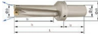
**Ausführung:** Vollbohrer 3xD mit Wendeschneidplatten. Zylindrischer Schaft mit gerader Spannfläche ISO 9766, Werkzeugträger vernickelt. **Lieferung ohne Wendeschneidplatten, ohne Schraubendreher.**
