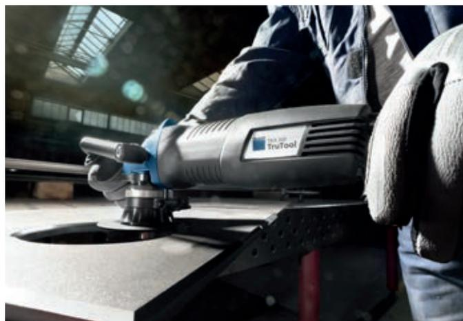
**Schweißkantenformer** TruTool TKF 1500 mit Werkzeug
