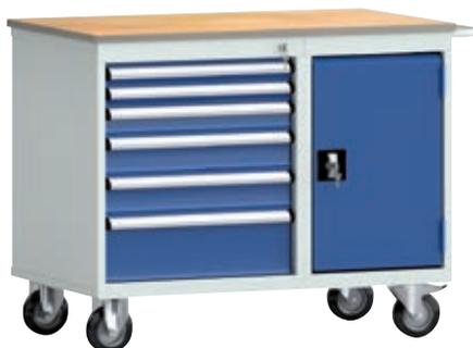
1.000 × 620 × 830 mm L × T × H, mit Buchen-Multiplexplatte 1000 × 620 × 20 mm und folgender Ausstattung: links: 50EA/50EA/75EA/100EA/100EA/175EA; rechts: Türe 550 mm (ohne Fachboden), mit Schiebepögel; sowie 2 Lenkrollen mit Feststeller und 2 Bockrollen (Ø 125 mm).
