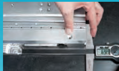
Messung eines Abstands mit einem Tiefenmessschieber für die Werkstatt
