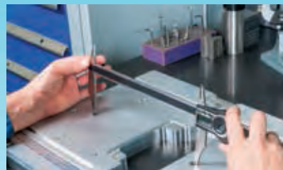
Bohrungsmessung nach der maschinellen Fertigung
