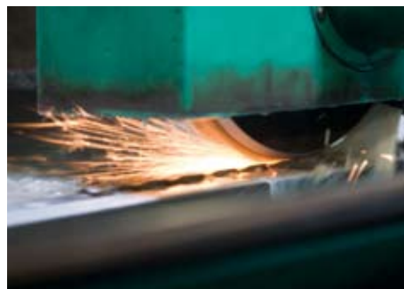
3. Vollautomatischer Schleifprozess für Profilschleifen
