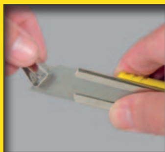
Sicheres Abbrechen verbrauchter Segmente
