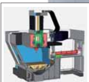
Aufbau GS-3 Achsen Bearbeitungszentrum
