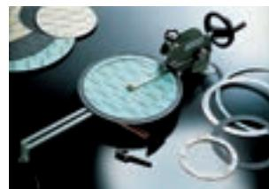
Für Dichtungen von 80 bis 1250 mm
