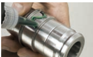
Klebstoffe zum Fügen von Welle-Nabe-Verbindungen
