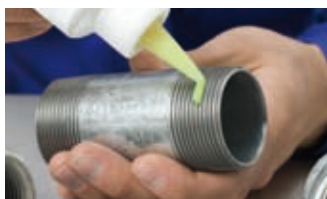
Dichtmasse für Hochdruckleitungen / Klebstoffe zur Gewindedichtung
