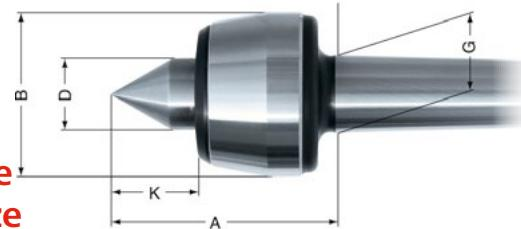
Laufspitze gehärtet und geschliffen, mit Spitzenwinkel 60°.
