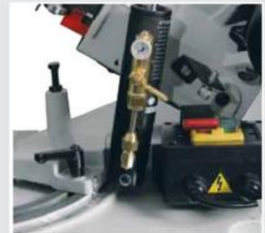
Absenkung • Hydraulischer Zylinder, stufenlos einstellbar • Grundplatte, Schwenkarm und Sägebügel aus stabilem Grauguß
