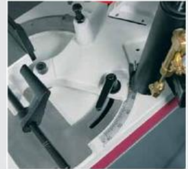
Sägebügel • Beidseitig von -45° bis +60° schwenkbar
