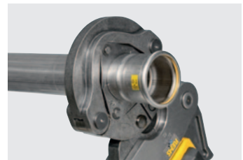
REMS Pressring (PR) mit 3 an einem gelenkigen Ring schwenkbar geführten Presssegmenten für anspruchsvolle Pressungen großer Dimensionen. Optimale Pressung durch radial gesteuerte Bewegung der Presssegmente, mit Zwischenzange.
