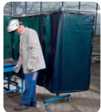
T55 Schweißer-Schutzvorhänge werden zur Abtrennung des Schweißarbeitsplatzes, vorzugsweise zum Gang hin, verwendet. Das Material ist durchsichtig, bei ausreichender Ausleuchtung der Kabine nimmt man die dahinter befindlichen Personen gut wahr. Trotzdem sind Augen und Haut von unbeteiligten Personen sicher geschützt.
