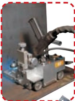
Der Schweißtraktor Wel Handy Multi Standard kann zum Horizontal- und Vertikalschweißen eingesetzt werden. Zur Erhöhung der Produktivität und Reduzierung von Hitzeverformungen lässt er sich problemlos mit der TWIN TORCH-Halterung (Zwillingsbrenner) erweitern.
