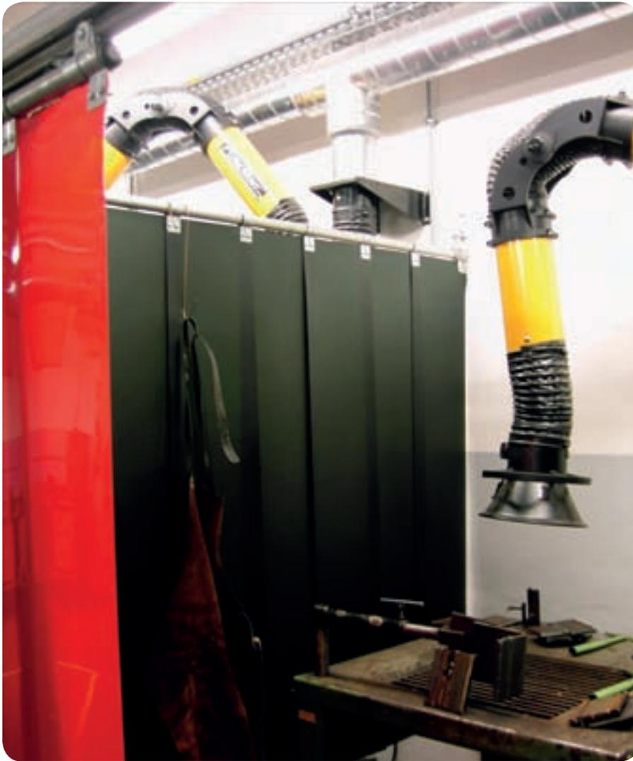
T75M Schweißer-Schutzvorhänge werden als Schweißarbeitsplatzabtrennung eingesetzt, um zusätzlich zum Strahlungsschutz Irritationen der Schweißer zu vermeiden. Das Material ist blickdicht, bei Zündung des Lichtbogens nimmt man die dahinter befindlichen Personen als Schatten wahr. Das Material wird aus diesem Grund hauptsächlich als Trennwand zwischen nebeneinanderliegenden Schweißarbeitsplätzen eingesetzt.
