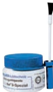
Weichlötflussmittel zum Löten von Kupferrohren in der Kalt- und Warmwasserinstallation gemäß DVGW-Arbeitsblatt GW 7. Diese Paste nur in Verbindung mit FELDER-Fittingslot „Cu-Rotin®“ verwenden. Die Flussmittelrückstände sind kaltwasserlöslich.
