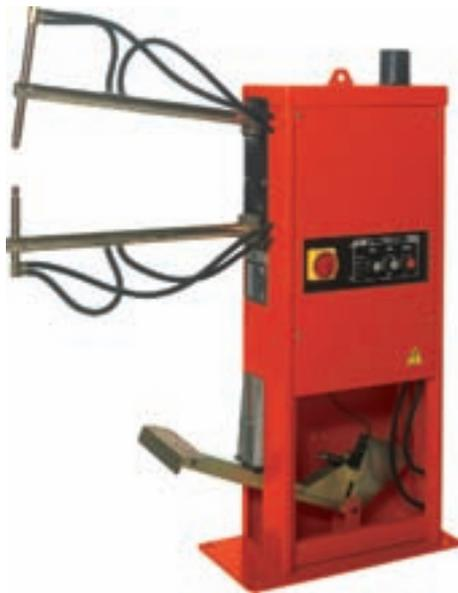
Fußbetätigte oder pneumatische, wassergekühlte Schwinghebelpunktschweißmaschinen, ausgestattet mit elektronischer Steuerung TE 25 analog oder TE 90 MARK II digital mit 2 Programmen. Die Arme sind ausziehbar mit gerade oder schräg montierbarem Halter aus Chromkupfer. Sowohl der Elektrodenhub als auch die Elektrodenkraft sind stufenlos einstellbar. Der epoxidharzvergossene Trafo ist ebenso wie Arme, Elektrodenhalter und Elektroden wassergekühlt.
