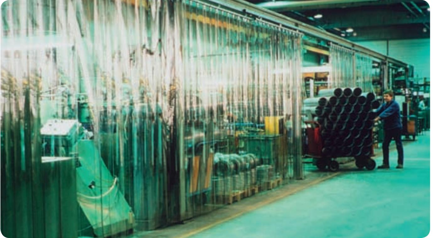
T0 Schutzvorhänge werden zur Abgrenzung von Arbeitsplätzen gegen Staub, Schmutz, Spritzer und Funken verwendet (nicht für Lichtbogenschweißen geeignet). Auch zur Trennung von Edelstahl und Schwarzstahlarbeitsplätzen sind die Vorhänge bestens geeignet. Das Material ist durchsichtig. Man nimmt die dahinter befindlichen Personen gut wahr. Unbeteiligte Personen sowie Gegenstände sind sicher geschützt.
