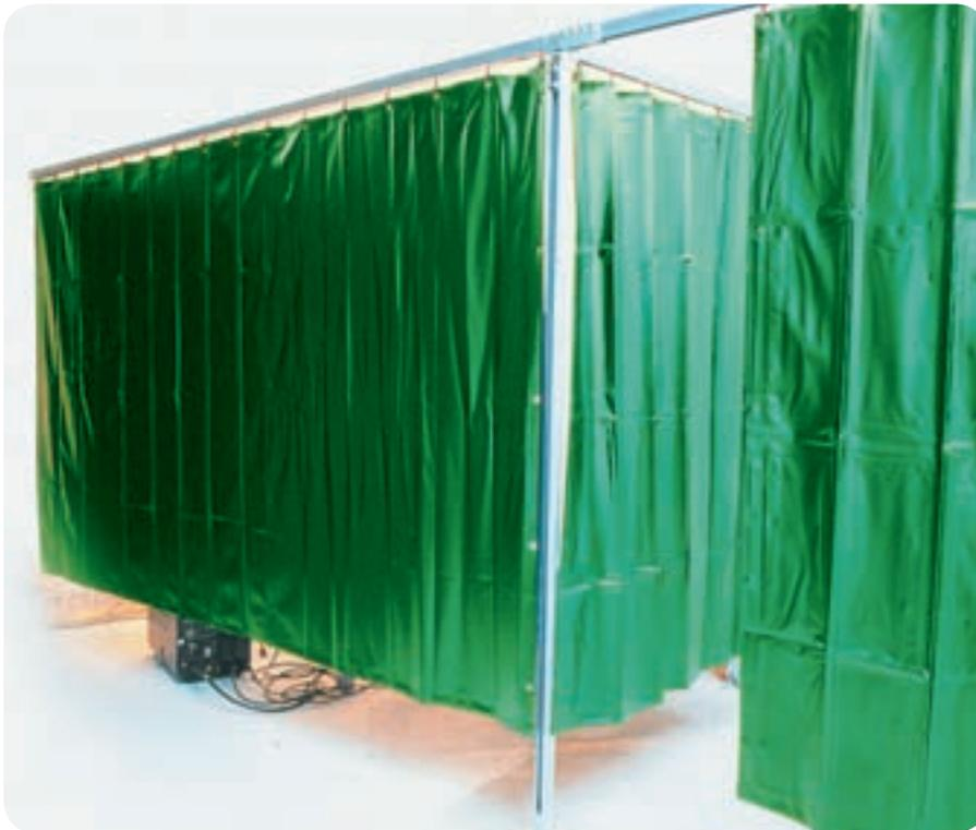
T75M Schweißerschutzvorhänge werden als Schweißarbeitsplatzabtrennung eingesetzt, um zusätzlich zum Strahlungsschutz Irritationen der Schweißer zu vermeiden. Das Material ist blickdicht, bei Zündung des Lichtbogens nimmt man Personen als Schatten in der Kabine wahr. Das Material wird aus diesem Grund hauptsächlich als Trennwand zwischen nebeneinanderliegenden Schweißarbeitsplätzen eingesetzt.
