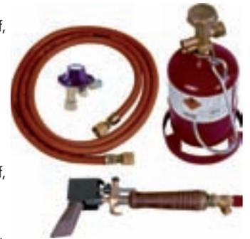
**Garnitur 26245:** LötKolben mit Handgriff, Kolbenbrenner mit Kolbenhalter, Windschutz, Kupferstück 350 g Spitzform, 2 m HD-Schlauch G 3/8", Kleinstflasche 425 g, mit Aufhängehaken, Füllmenge und Kleinregler 1,5 bar (fest eingestellt).
