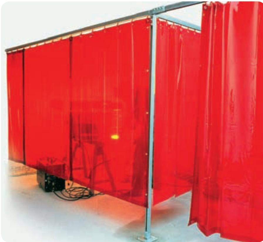
T40 Schweißer-Schutzvorhänge werden zur Abgrenzung des Schweißarbeitsplatzes eingesetzt. Das helle Rot-Orange bringt Farbe in den dunklen Schweißbetrieb. Das Material ist durchsichtig, bei ausreichender Ausleuchtung der Kabine nimmt man die dahinter befindlichen Personen gut wahr. Trotzdem sind Augen und Haut von unbeteiligten Personen sicher geschützt.
