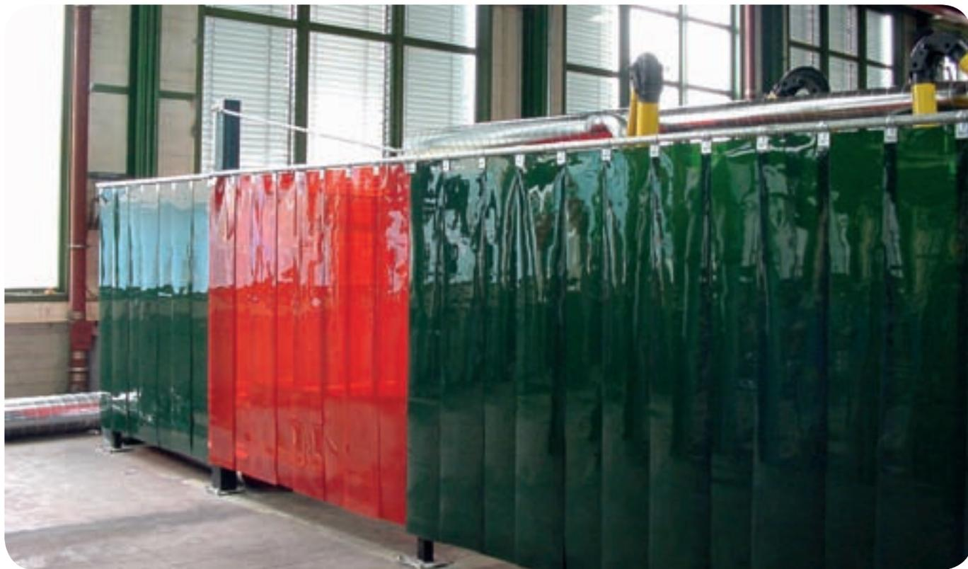
T55 Schweißer-Schutzlamellen werden zur Abgrenzung des Schweißarbeitsplatzes, vorzugsweise zum Gang hin verwendet. Das Material ist durchsichtig, bei ausreichender Ausleuchtung der Kabine nimmt man die dahinter befindlichen Personen gut wahr. Trotzdem sind Augen und Haut von unbeteiligten Personen sicher geschützt.
