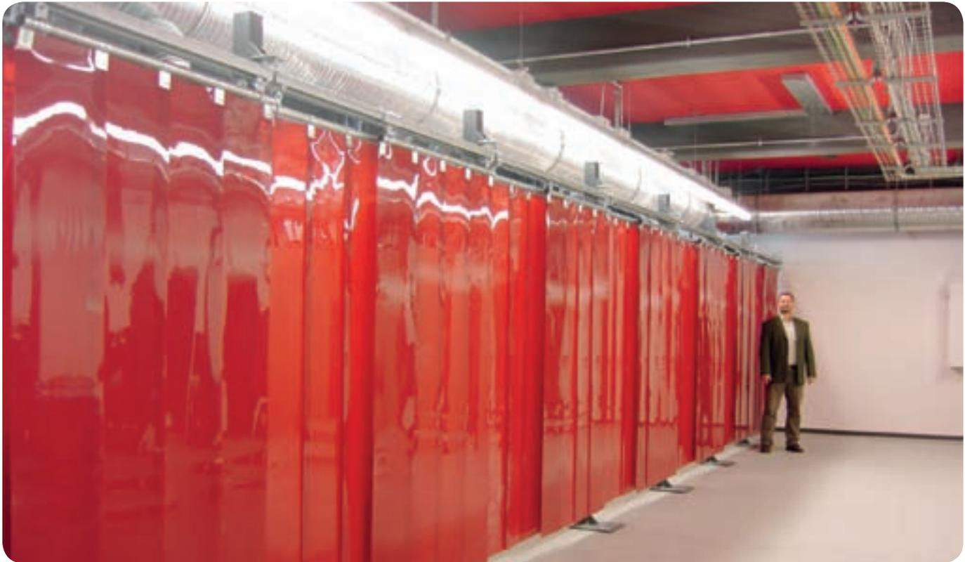
T40 Schutzlamellenvorhänge werden zur Abgrenzung des Schweißplatzes eingesetzt. Das helle Rot-Orange bringt Farbe in die meist dunklen Schweißbetriebe. Das Material ist durchsichtig. In der Kabine nimmt man die dahinter befindlichen Personen gut wahr. Trotzdem sind Augen und Haut von unbeteiligten Personen sicher geschützt.
