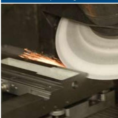
Schleifen der Schwalbenschwanzführung
